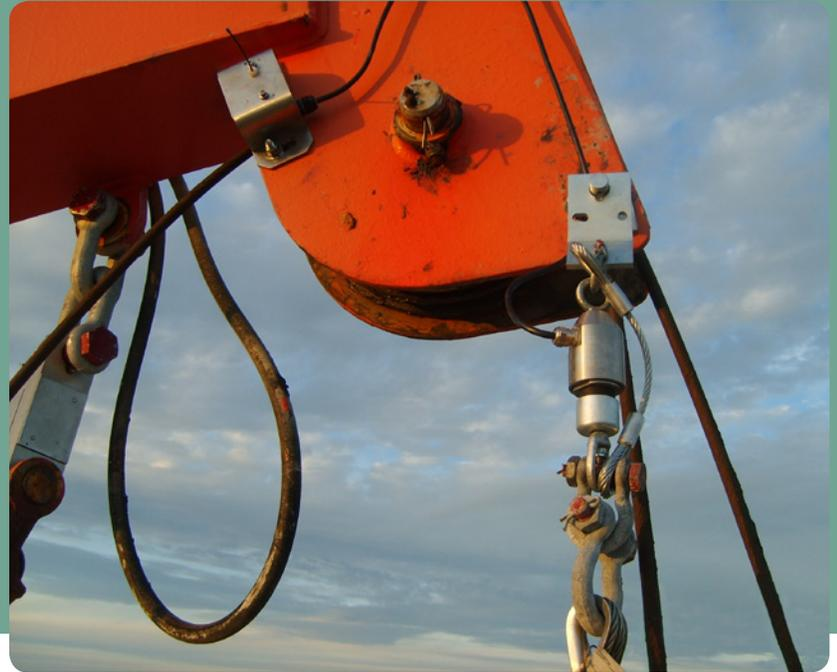
El LS055 Interruptor A2B Acero Inoxidable está encerrado completamente en acero inoxidable 304. Los cáncamos son galvanizados, por eso el LS055 es una solución ideal para cualquier ambiente corrosivo.
