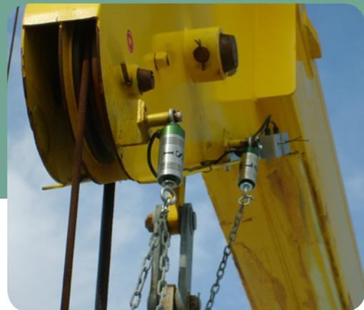
El interruptor A2B mecánico más eficaz del mercado, con un mecanismo interruptor que es reemplazable por el usuario, y un resistor incorporado de 4.700 ohmios para integración con sistemas de otras marcas sin problemas.
